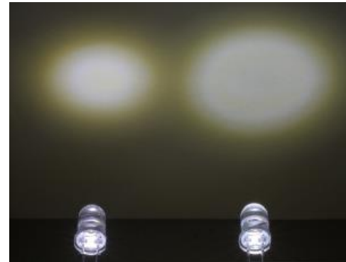
Figura 2 Due LED con lenti diverse proiettati su una parete
