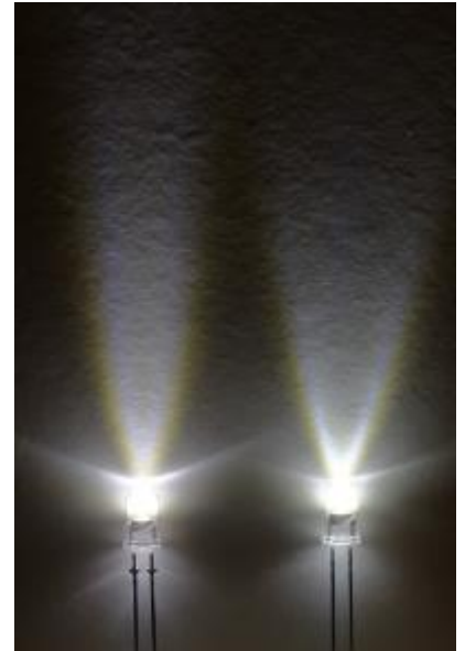
Figura 1 Due LED con lenti diverse
